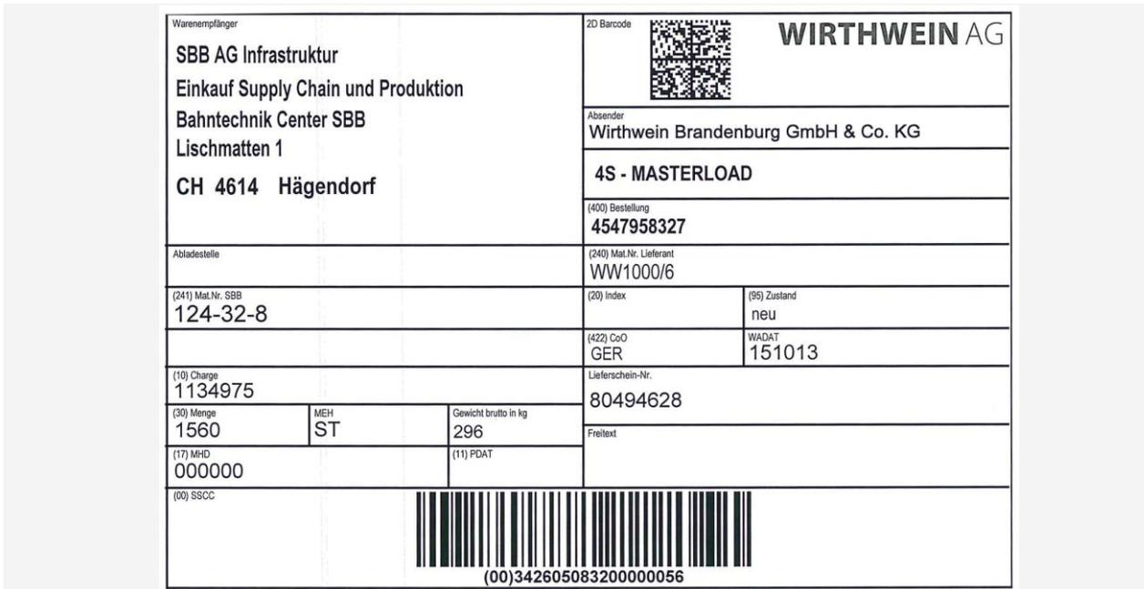
Abbildung 3-3: Beispiel einer Logistiketikette mit SSCC und GS1-128
