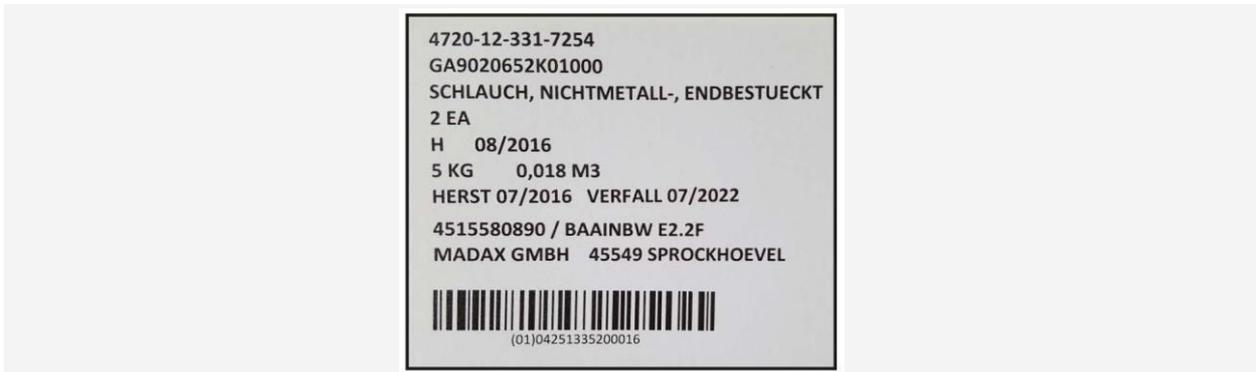
Abbildung 3-2: Beispiel einer gedruckten Produktetikette mit GTIN im GS1-128
