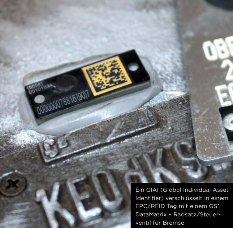
Ein GIAI (Global Individual Asset Identifier) verschlüsselt in einem EPC/RFID Tag mit einem GS1 DataMatrix - Radsatz/Steuer-ventil für Bremse
