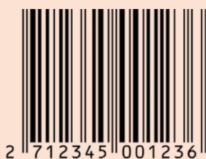
EAN-13 mit Präfix „27“, HPID „12345“ und einem Nettogewicht von 0,123 kg
