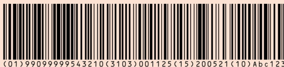
Variable Handelseinheit, Verschlüsselung einer GTIN-14 (990999999543210, mit Indikator 9 für variable Einheiten), mit Nettogewicht (1,125 kg), Mindesthaltbarkeitsdatum (21.05.2020) und Chargennummer (Abc123)
