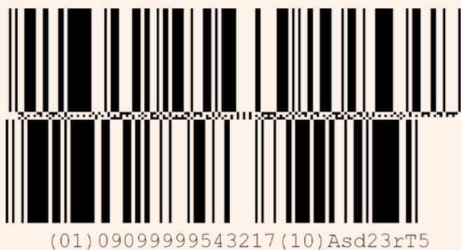
Artikelnummer (GTIN) und Chargennummer verschlüsselt in einem GS1 DataBar Expanded Stacked
