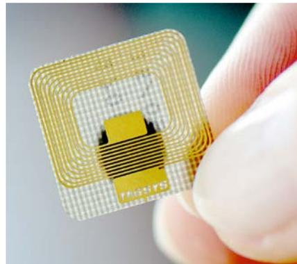
Im Bereich der FMCG (Fast Moving Consumer Goods) wird die RFID-Technologie aus Gründen der Rückverfolgbarkeit zur Kennzeichnung von Behältern, Paletten oder Umverpackungen verwendet.
