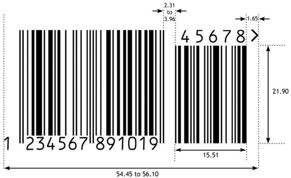
Abbildung 5.2.6.6-6. EAN-13 Strichcode mit fünfstelligem Zusatzsymbol
