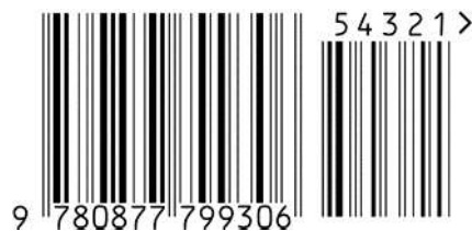
Abbildung 5.2.2.5.2-2. EAN-13 Strichcode mit einem fünfstelligen Zusatzsymbol
