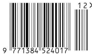
Abbildung 5.2.2.5.1-2. EAN-13 Strichcode mit einem zweistelligen Zusatzsymbol
