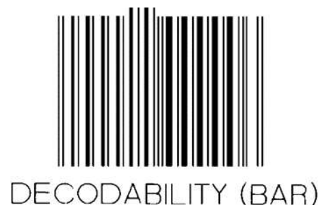
Abbildung 5.10.5.12-3. Symbol zur Kalibrierung mit einer bewusst niedrigen Klassifizierung der Decodierung
