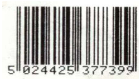
Abbildung 5.10.5.12-1. Symbol mit Problemen bei der Kantenvermessung
