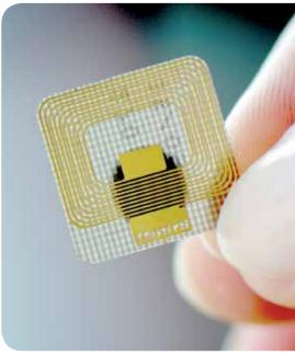
Wertschöpfungsketten sind am effizientesten und weisen die geringsten Kosten auf, wenn die Abläufe automatisiert sind und die Daten direkt ausgelesen und ins System übernommen werden können. Dazu dienen automatische Identifikationssysteme, die mit Scannern und RFID-Lesegeräten arbeiten, um Daten rasch zu erfassen. Die RFID-Technologie hat die zusätzliche Besonderheit der Pulkerfassung, mittels derer eine Vielzahl an Daten in einem Arbeitsschritt erfasst werden können.
