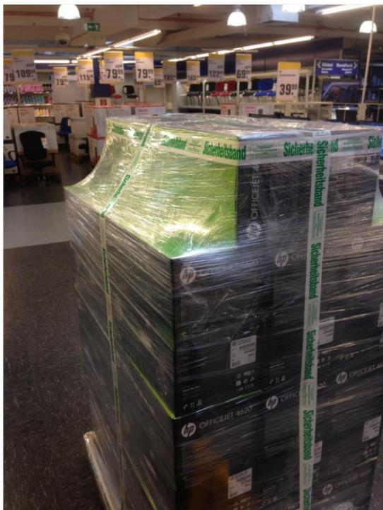
Abbildung 14: Kennzeichnung der Palette mit Klebeband
