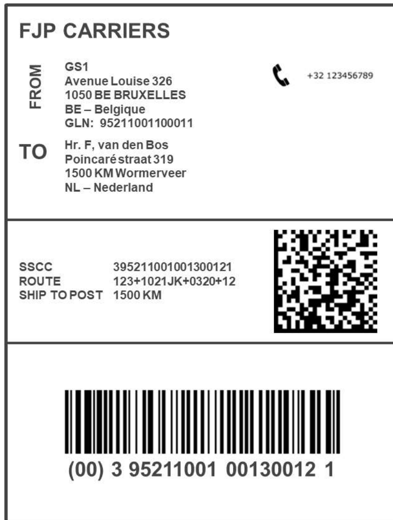
Abbildung 6.6.5-8. Etikett mit GS1 DataMatrix mit enthaltenen Lieferinstruktionen
