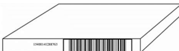
Abbildung 6.7.1.3-2. Symbolplatzierung auf flachen Behältern
