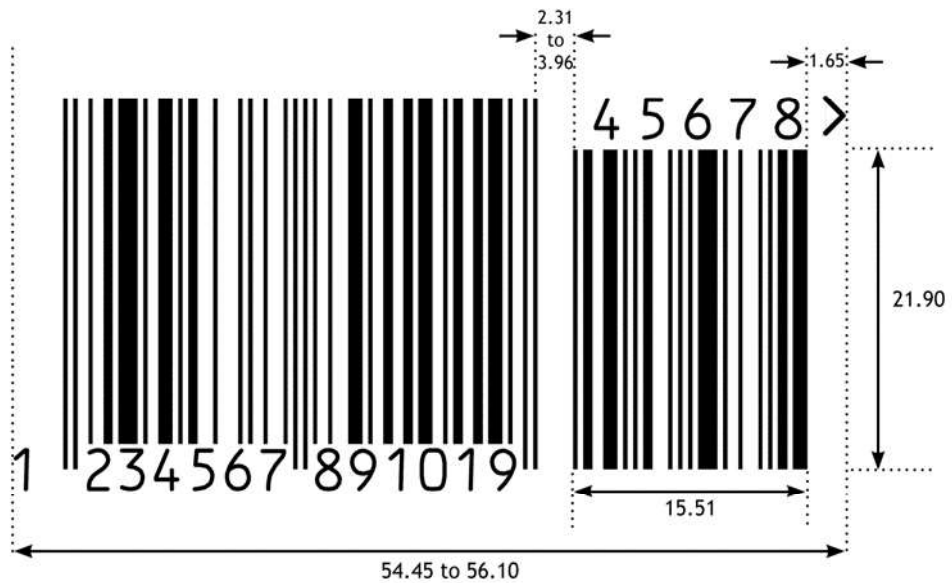
Abbildung 5.2.6.6-6. EAN-13 Strichcode mit fünfstelligem Zusatzsymbol
