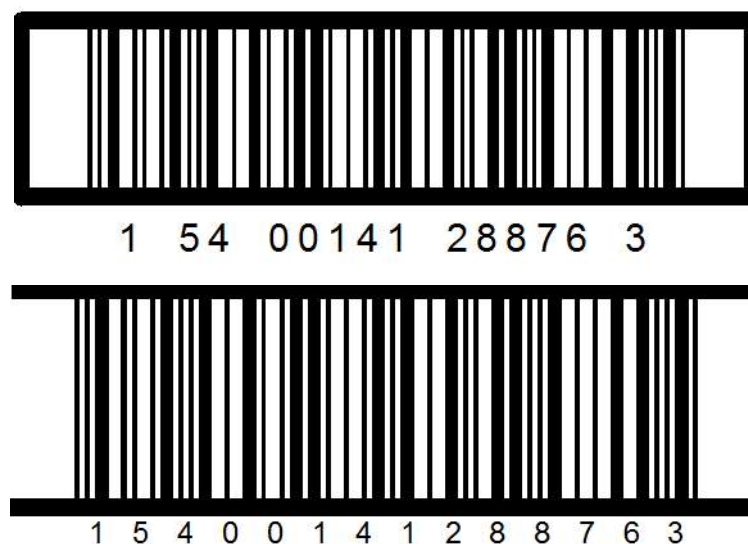
Abbildung 5.3.2.4-1. Beispiele von Trägerbalken
