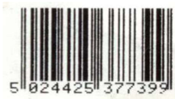
Abbildung 5.12.5.12-1. Symbol mit Problemen bei der Kantenvermessung
