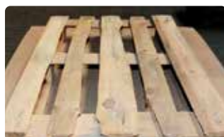
Unzulässiges Bauteil, z.B.: untermaßig, morsch, Baumkante
