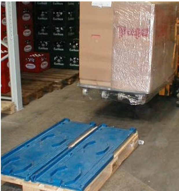
Abbildung 24 - Adapterpaletten der Firma Gebhardt und Container Centralen
