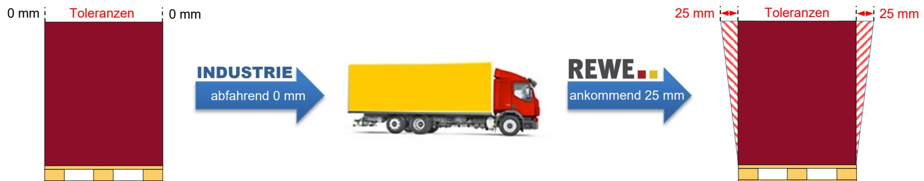
Mögliche Arten von Transportsicherung sind z.B. Folien (ausschl. transparent, **auf freie Gabelräume achten!**), Umreifungen, Zwischenlagen. Da mit Klebepunkten als Transportsicherung erfahrungsgemäß gravierende Probleme in der Kommissionierung entstehen, sind diese möglichst zu vermeiden.
