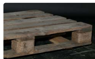
Keine vorgeschriebene Kennzeichnung mehr lesbar
