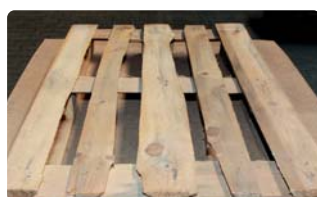
Unzulässiges Bauteil, z.B.: untermaßig, morsch, Baumkante
