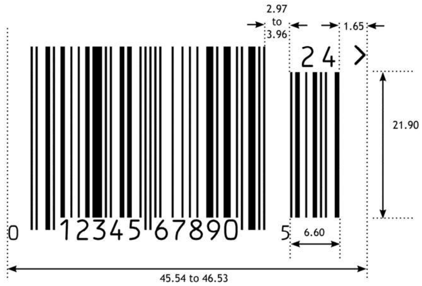
Abbildung 5.2.6.6-5. UPC-A Strichcode mit zweistelligem Zusatzsymbol
