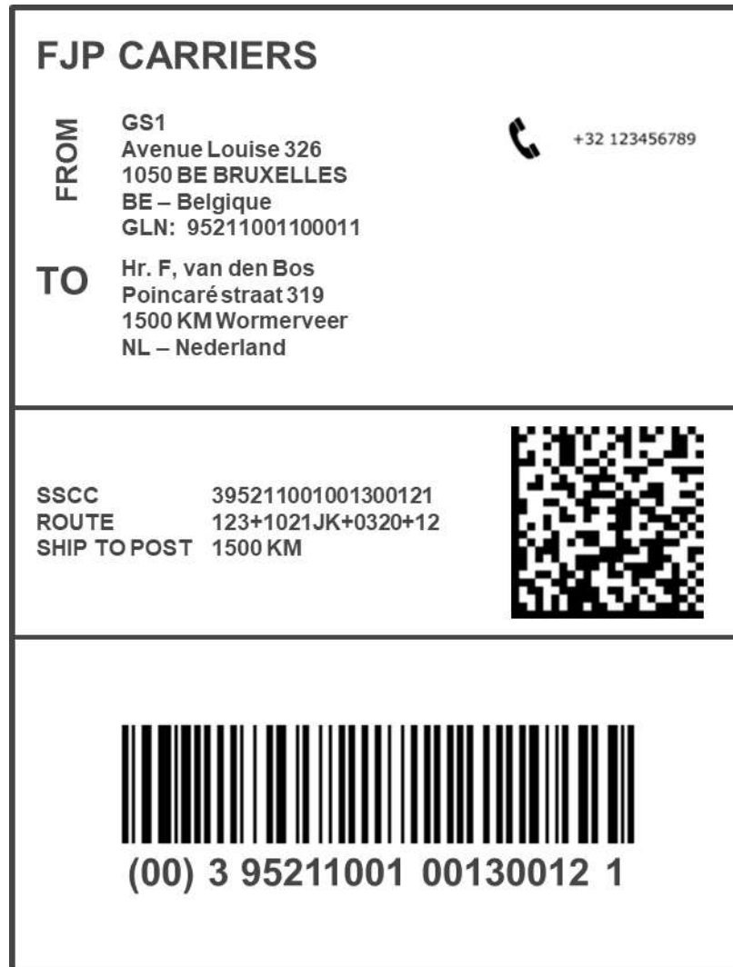
Abbildung 6.6.5-8. Etikett mit GS1 DataMatrix mit enthaltenen Lieferinstruktionen
