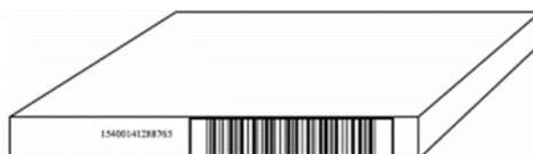
Abbildung 6.7.1.3-2. Symbolplatzierung auf flachen Behältern
