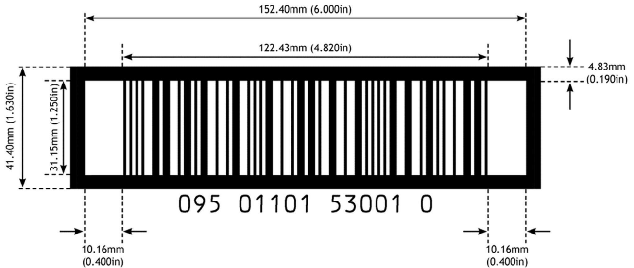
Abbildung 5.3.6-1. ITF-14 Symbol: Abmessungen bei einer X-Modulbreite von 1,016 mm (Nominalgröße) (0.040 in.)
