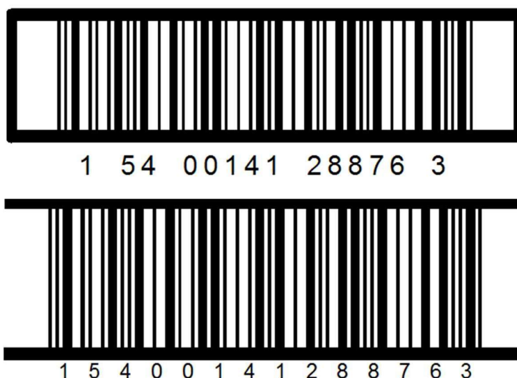
Abbildung 5.3.2.4-1. Beispiele von Trägerbalken
