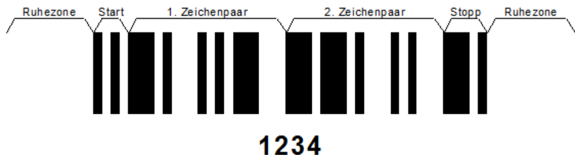
Abbildung 5.3.2.1.2-2. ITF-14 Symbol einschließlich der Ruhezonen
