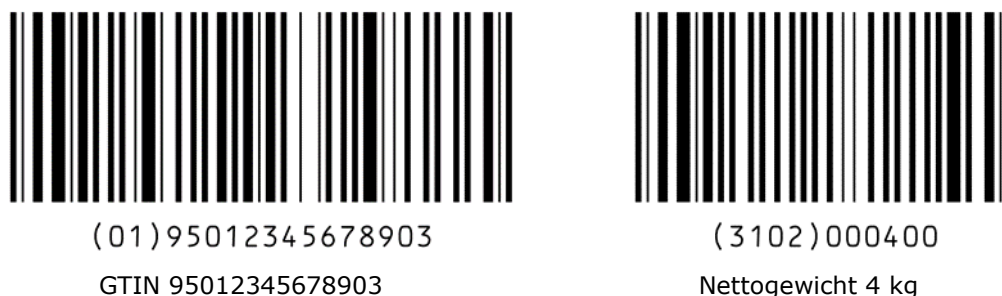
Abbildung 7.8.6.1-1. In zwei GS1-128 Symbolen verschlüsselte Daten
