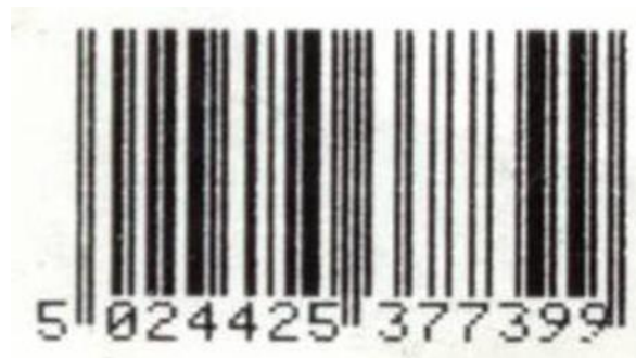
Abbildung 5.12.5.12-1. Symbol mit Problemen bei der Kantenvermessung
