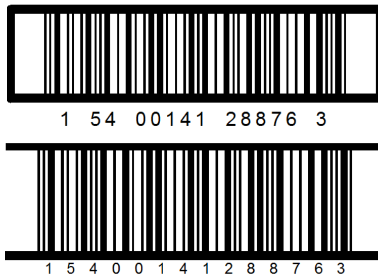
Abbildung 5.3.2.4-1. Beispiele von Trägerbalken
