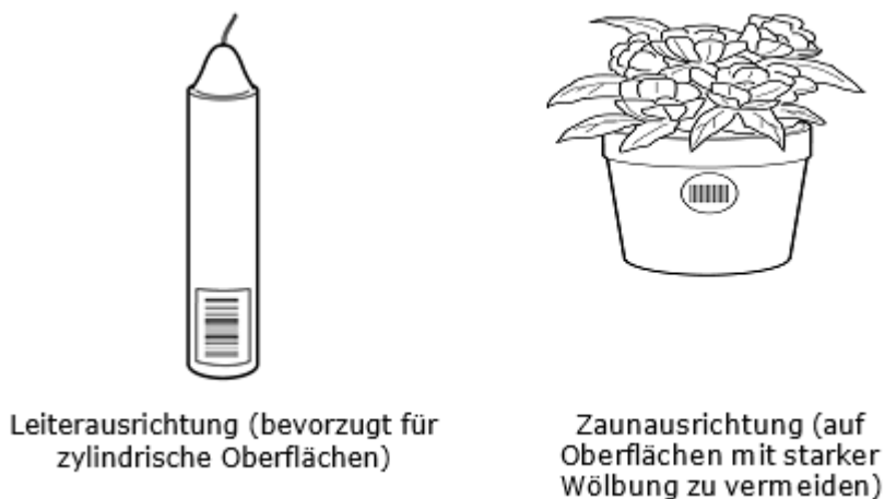
Abbildung 6.2.3.2-1. Barcodeplatzierung auf gewölbten Oberflächen
