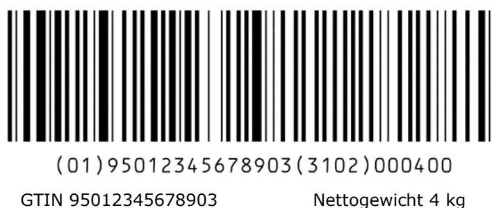
Abbildung 7.8.6.1-2. In einem GS1-128 Symbol verkettete Daten
