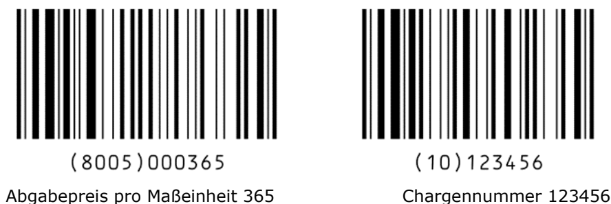
Abbildung 7.8.6.2-1. In zwei GS1-128 Symbolen verschlüsselte Daten
