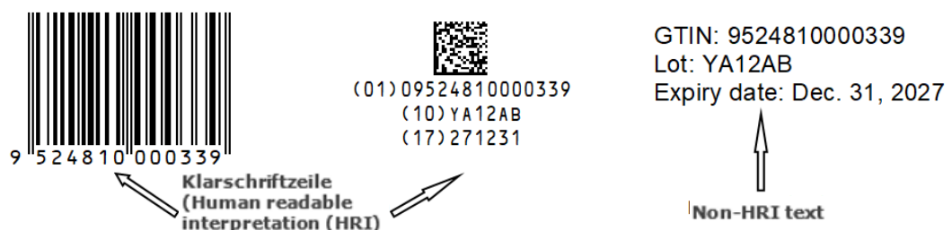
Abbildung 4.14-1. Beispiele zur Klarschriftzeile und Klartext (Non-HRI Text)
