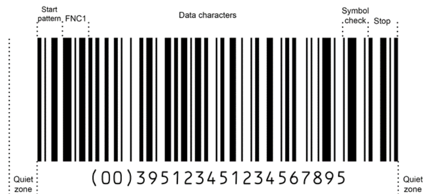
Abbildung 5.4.2-1. Allgemeines Format eines GS1-128 Strichcodes
