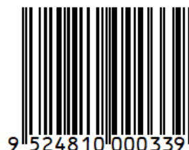
Abbildung 4.14.2-2. Beispiel eines EAN-13 mit Klarschriftzeile
