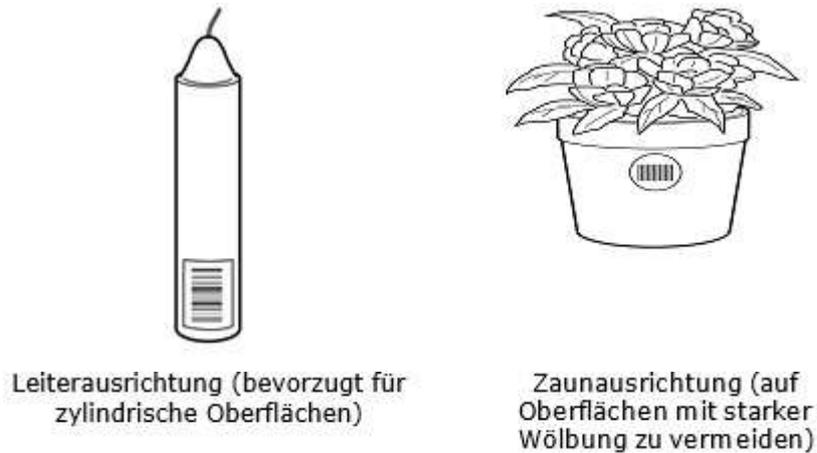
Der Winkel zwischen der Tangente in der Mitte des gewölbten Strichcodes und den Tangenten der Randzeichen (bei der EAN/UPC Symbollogi ist dies die äußere Kante der Randzeichen) MUSS weniger als 30° betragen. Falls dieser Winkel mehr als 30° beträgt, MUSS die Ausrichtung des Strichcodes so gewählt werden, dass die Striche senkrecht zur Umrisslinie der Einheit verlaufen.
