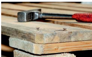
Einschlagen herausstehender Befestigungselemente.
