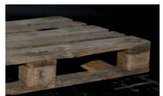
Keine vorgeschriebene Kennzeichnung mehr lesbar
