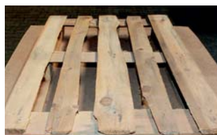
Unzulässiges Bauteil, z.B.: untermaßig, morsch, Baumkante
