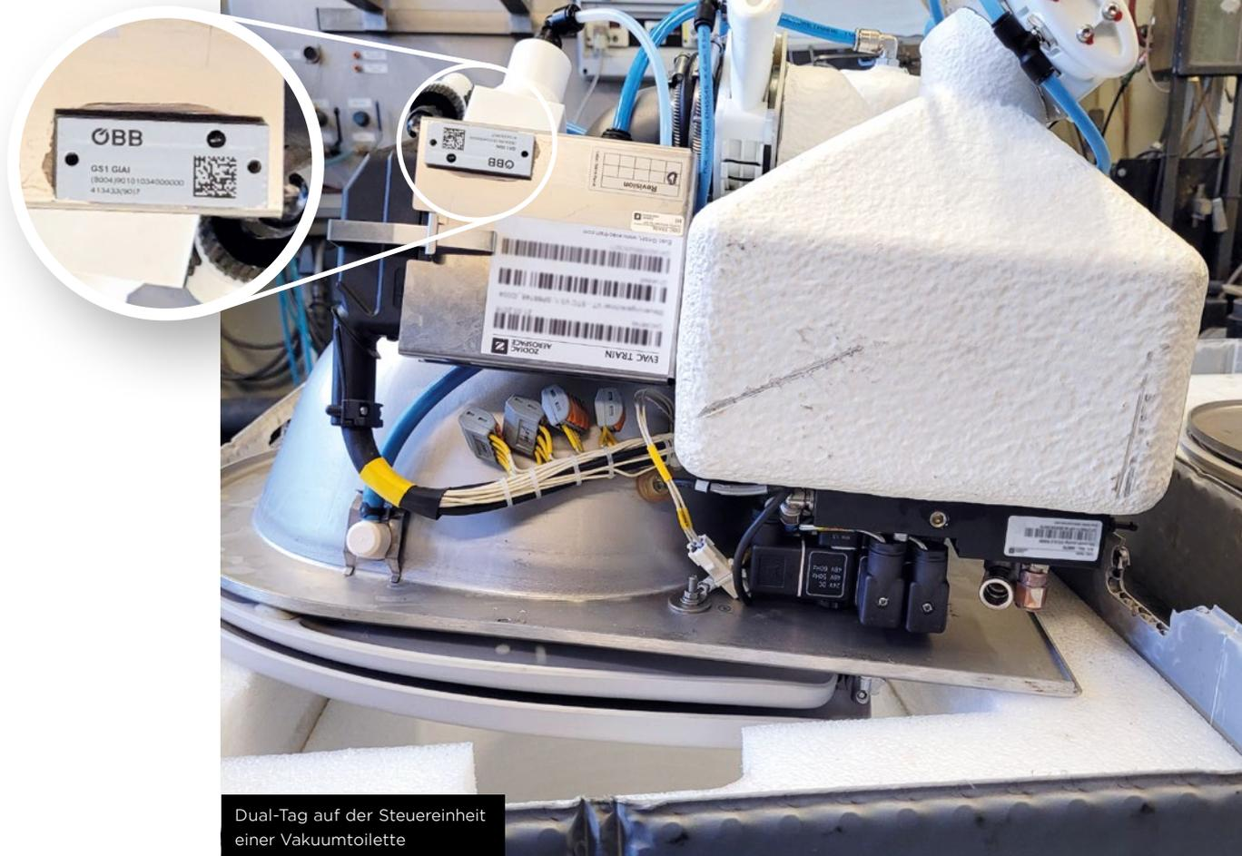
Dual-Tag auf der Steuereinheit einer Vakuumtoilette
