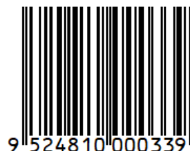
Abbildung 4-12 Beispiel eines EAN-13 mit Klarschriftzeile
