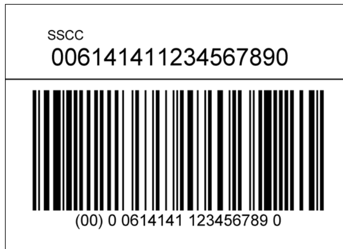
Abbildung 6-74 Basisetikett mit SSCC
