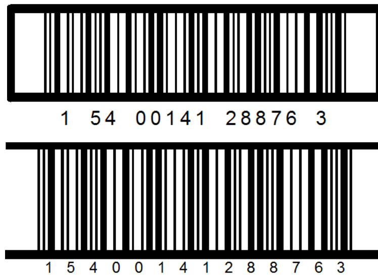
Abbildung 5-32 Beispiele von Trägerbalken
