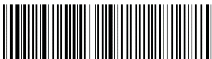
Abbildung 7-9 In zwei GS1-128 Symbolen verschlüsselte Daten
